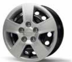
15" plechová kola s poklicemi a pneumatikami 195/65 R 15
