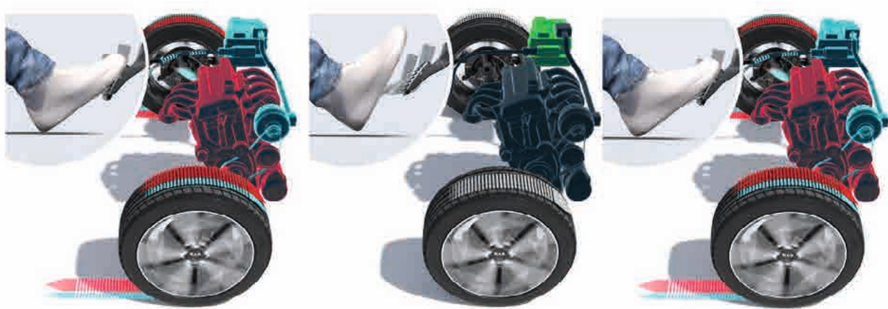
Zjednodušené zobrazení funkce setrvačné jízdy u verze Mild Hybrid
